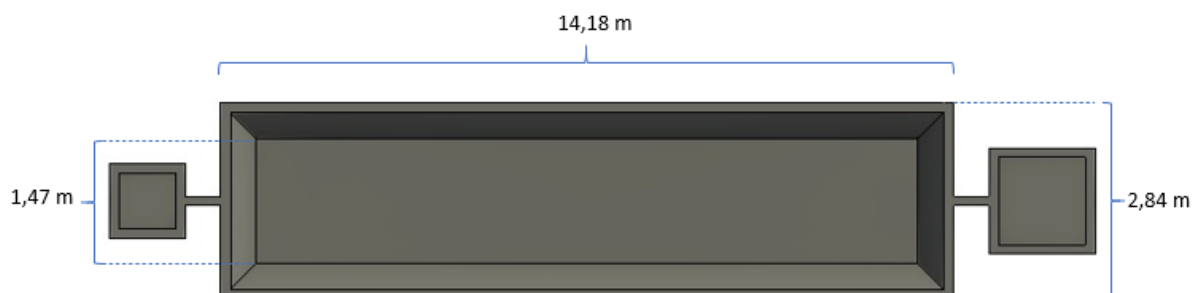
Figura 13 - Vista superior do biodigestor e as respectivas dimensões.
