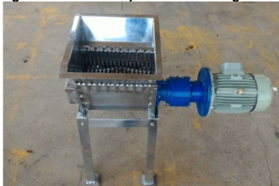
Figura 6 - Triturador para resíduos orgânicos.
