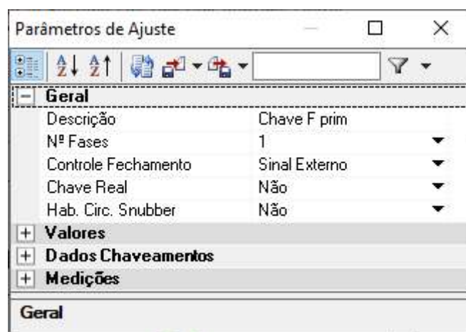
Figura 51. Parâmetros do bloco “Chv Tempo 1Ø” – para fazer a troca das bobinas do trafo.
