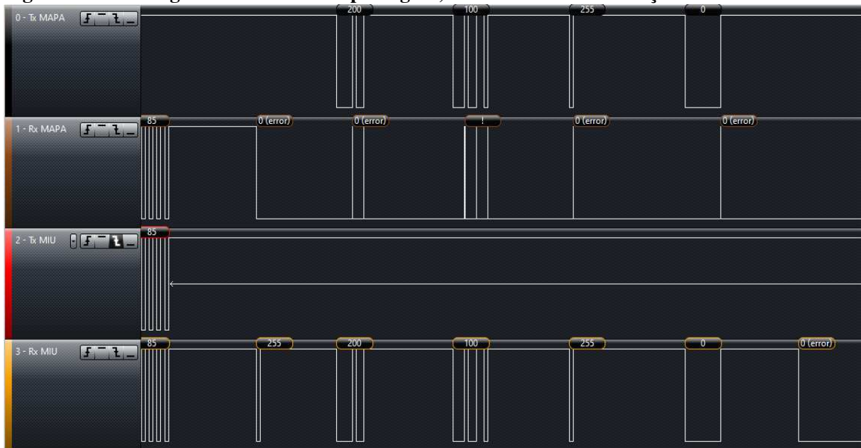
Figura 27: Sinal registrado no osciloscópio digital, mostrando a comunicação entre MIU e MAPA.
