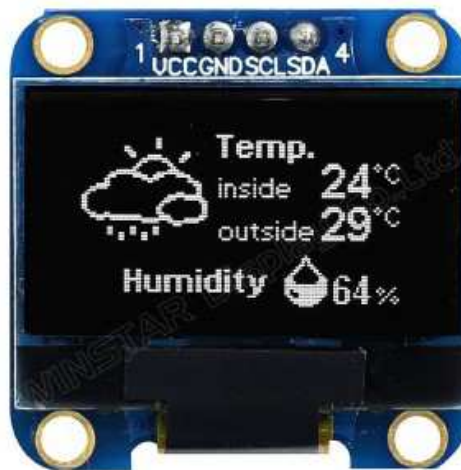
Figura 5: Módulo OLED monocromático de 128x64 pixels de resolução.
