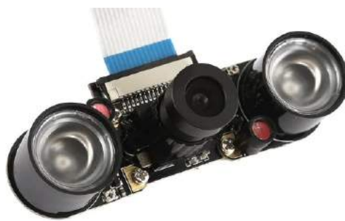
Figura 3.2: Câmera infravermelho utilizada para aquisição de imagens (reproduzido de Boxeletronica[43]).
