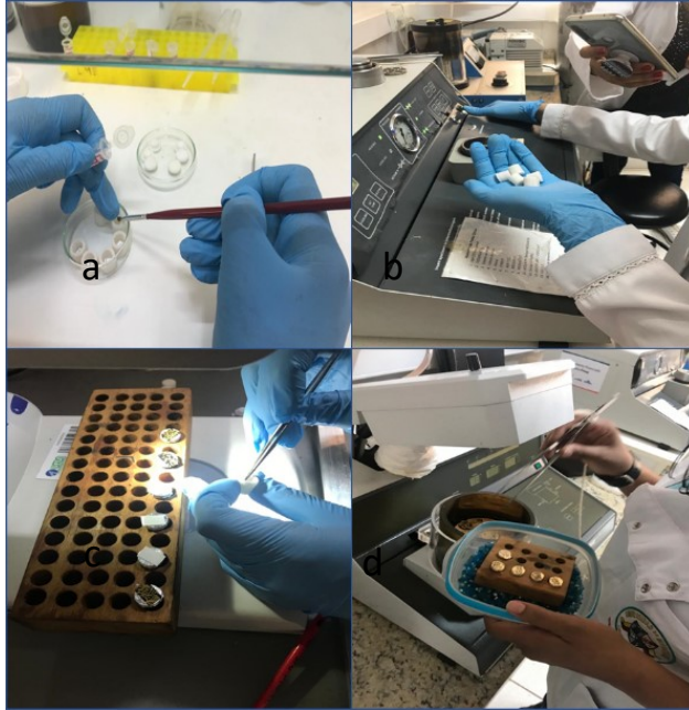
Figura 7 - Protocolo utilizado para a análise estrutural em microscópio eletrônico de varredura de larvas de Alphitobius diaperinus . (a) amostras dispostas em containers, (b) containers contendo as amostras submetidas a ponto crítico, (c) amostras dispostas em stambys revestidos com papel alumínio e (d) amostras submetidas a banho de ouro em aparelho Spuntter Coater BAL-TEC (SCD 050).
