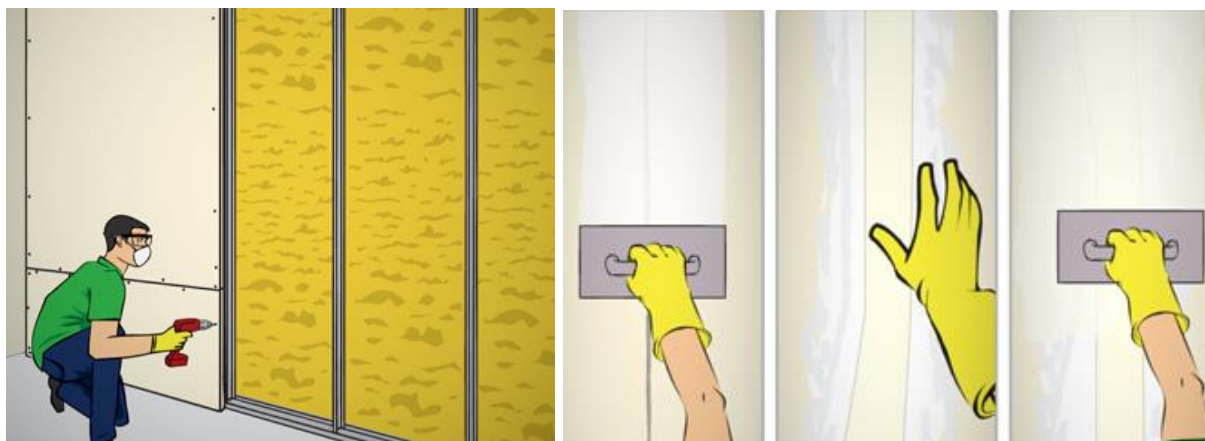
Figura 2.4 – Instalação das chapas do segundo lado e acabamento Fonte: Leroy Merlin, 2016.
