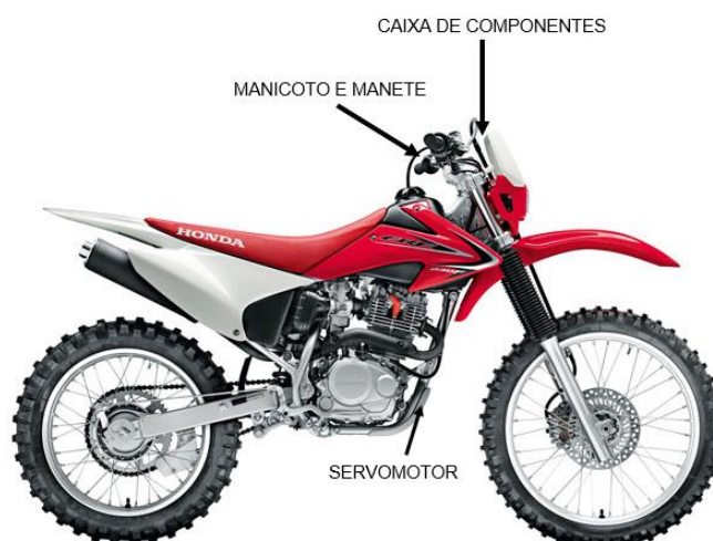
Figura 50 - Posicionamento dos componentes na motocicleta Honda CRF230F.
