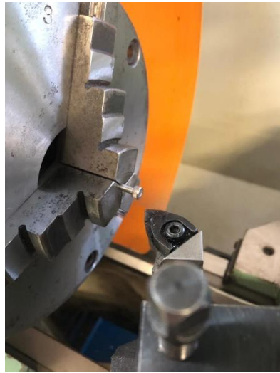
Figura 30 - Torneamento sendo realizado na cabeça do parafuso.
