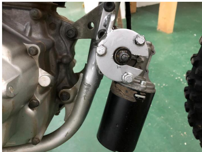
Figura 36 - Suporte instalado no quadro da motocicleta.
