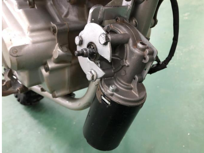
Figura 37 - Fixação do motor ao suporte de fixação.
