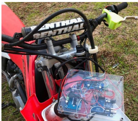
Figura 48 - Sistema elétrico instalado na motocicleta.
