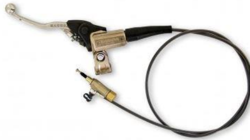
Figura 8 - Acionamento de embreagem tipo hidráulico.
