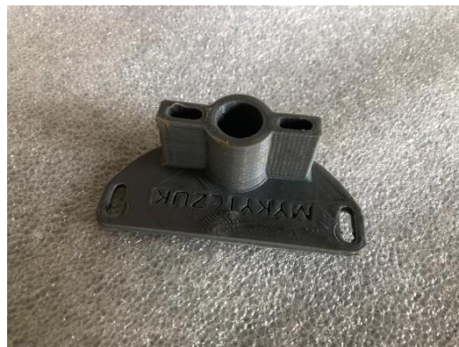
Figura 24 - Suporte inferior do potenciômetro de realimentação de posição do servomotor.
