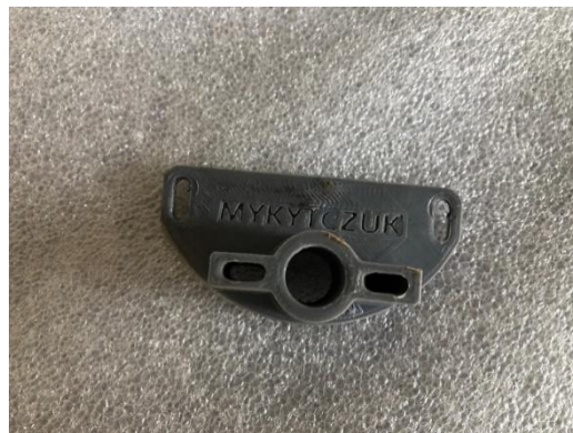
Figura 23 - Suporte inferior do potenciômetro de realimentação de posição do servomotor.
