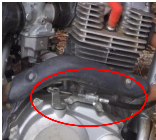
Figura 7 - Acionamento de embreagem via cabo de aço.
