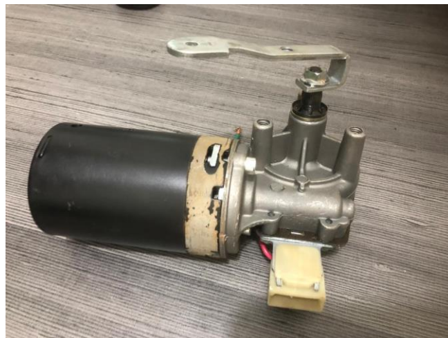
Figura 26 - Motor de limpador de parabrisas veicular.
