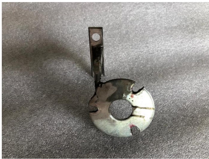
Figura 35 - Suporte de fixação do servomotor ao quadro da motocicleta.
