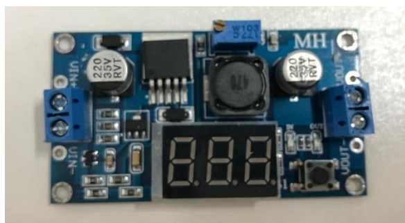
Figura 14 - Módulo Regulador de Tensão.
