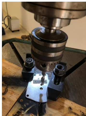
Figura 29 - Furo passante sendo realizado na tampa traseira da carcaça do motor.
