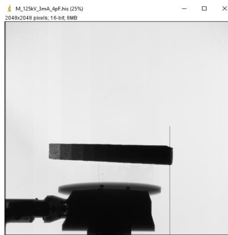
Imagem ImageJ – amostra de argamassa de limalha de ferro fundido 0,6mm (Traço 1) e com aplicação de energia 125 KeV
