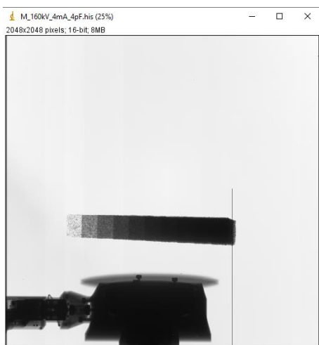
Imagem ImageJ – amostra de argamassa de limalha de ferro fundido 0,6mm (Traço 1) e com aplicação de energia 160 KeV
