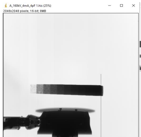
Imagem ImageJ – amostra de concreto e com aplicação de energia 160 keV
