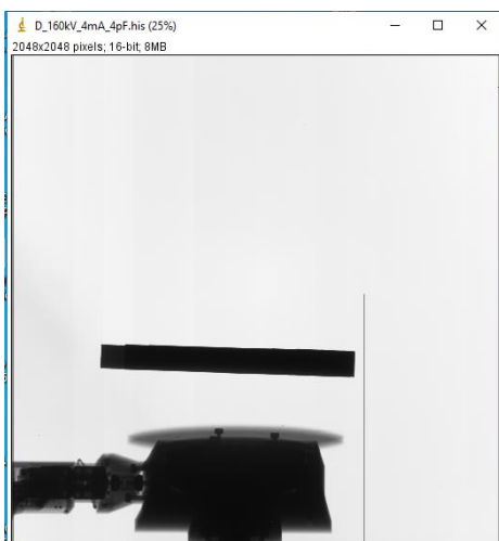
Imagem ImageJ – amostra de chumbo e com aplicação de energia 160 KeV
