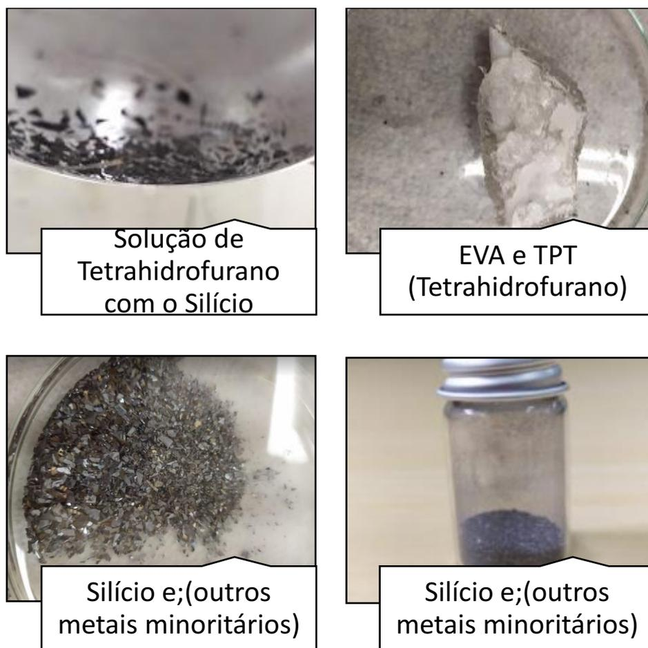
Figura 22 – Amostra obtida após 48 horas por delaminação por solvente com o reagente Tetrahidrofurano
