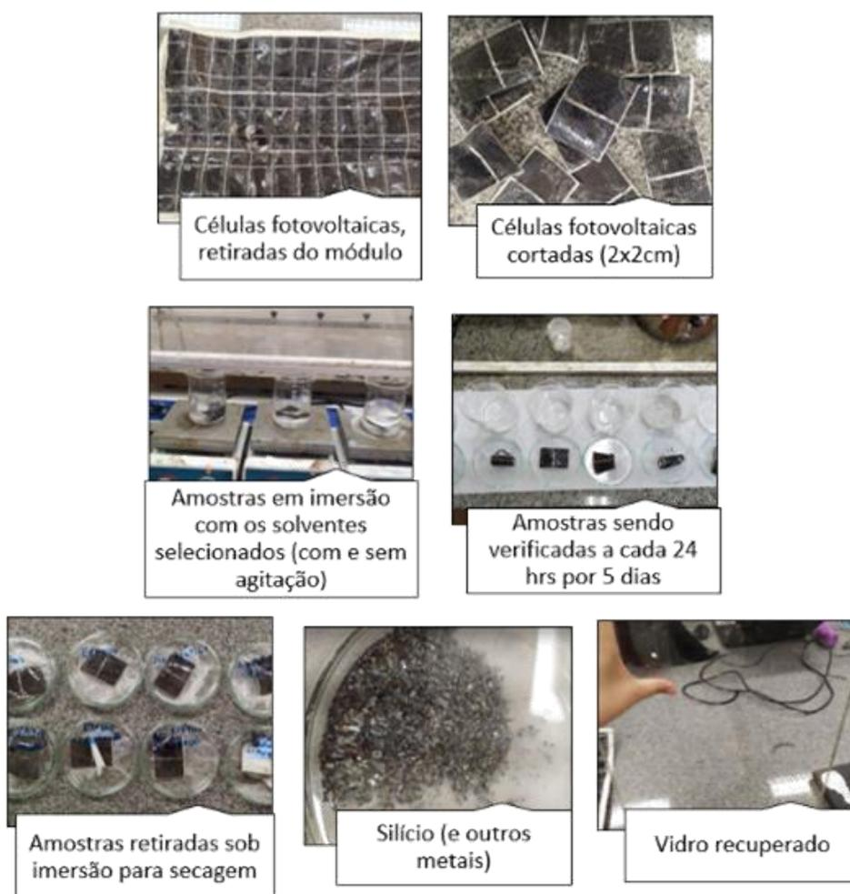
Figura 19 – Fotografias das amostras em delaminação por solvente
