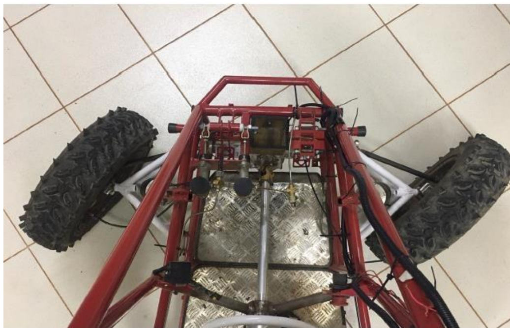
Figura 9 - Geometria de Ackerman Veículo da Equipe Londribaja.
