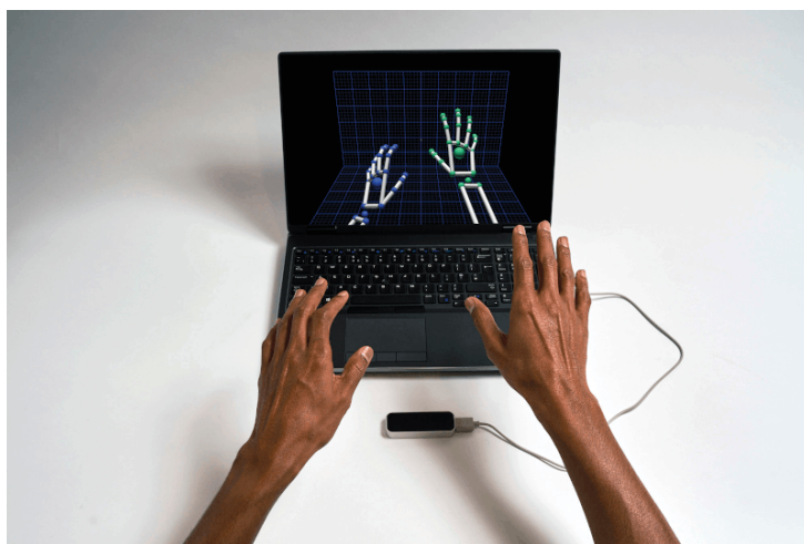
Figura 2.2: Leap Motion Controller em funcionamento [9].
