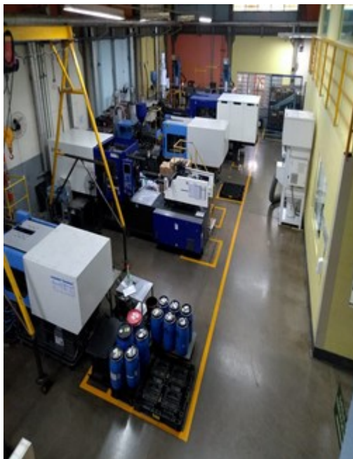
Figura 02 - Fotografia da vista superior do setor de injeção
