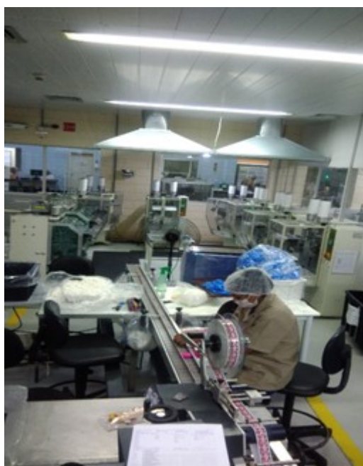
Figura 04 - Vista setor de fio dental, com as áreas de confecção de carretéis e montagem
