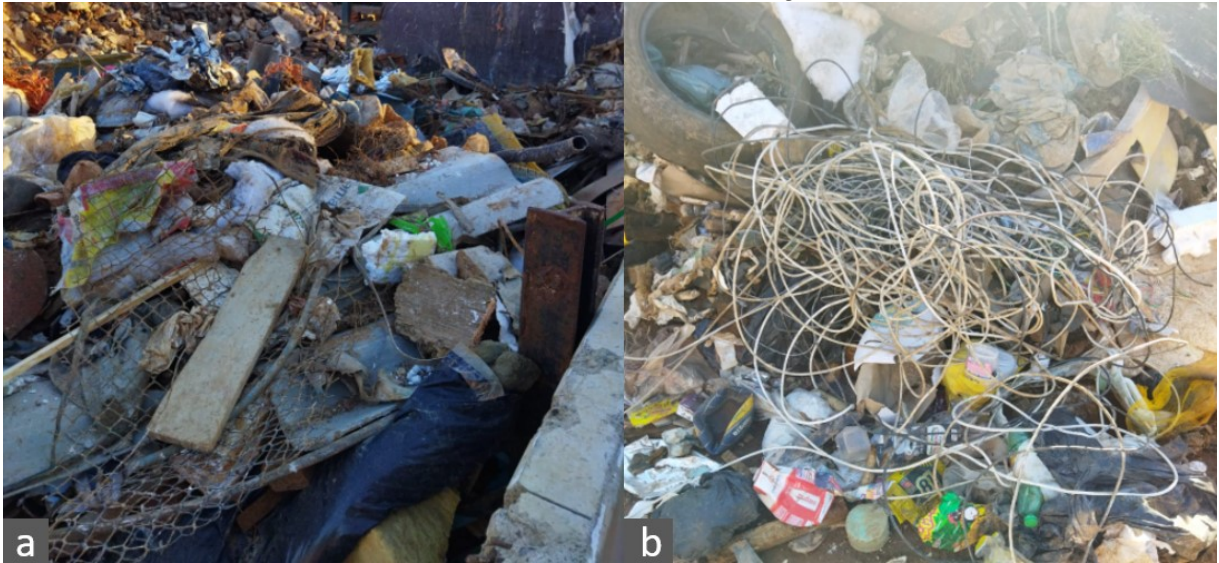
Figura 12 - Contaminantes presentes juntamente com os RCC. 12a e 12b: Exemplos de contaminantes encontrados nas caçambas
