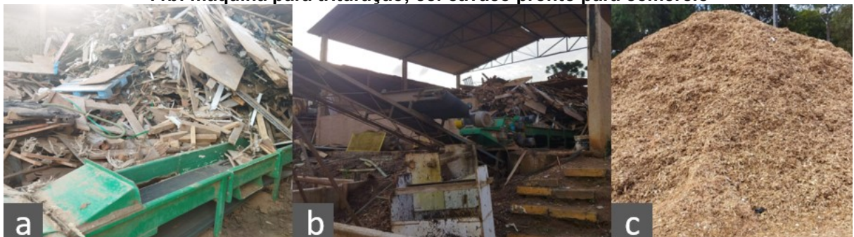
Figura 11 - Tratamento da madeira recebida pela usina.11a: pilha de madeira a ser triturada; 11b: máquina para trituração; 8c: cavaco pronto para comércio
