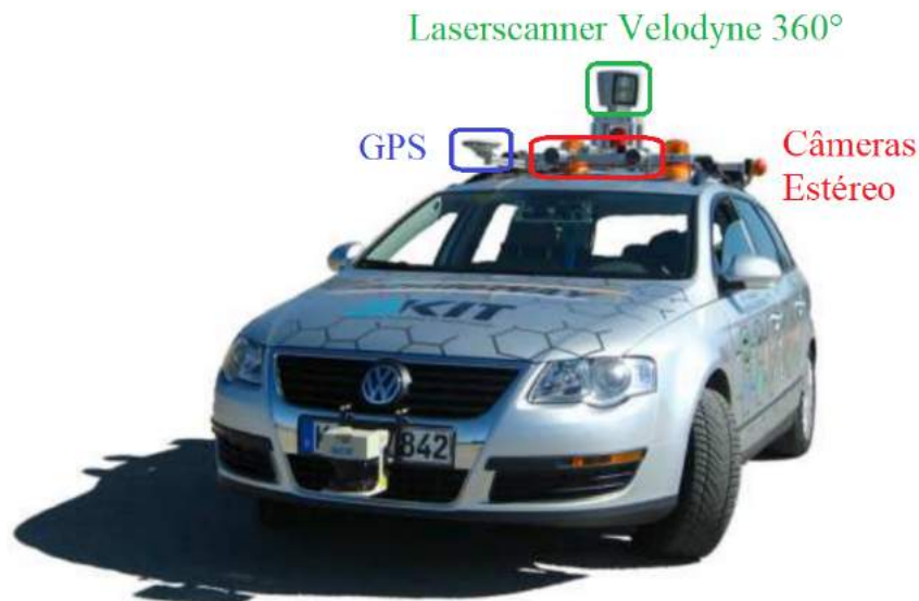
Figura 20 – Configuração veicular para obtenção dos dados do conjunto KITTI.
