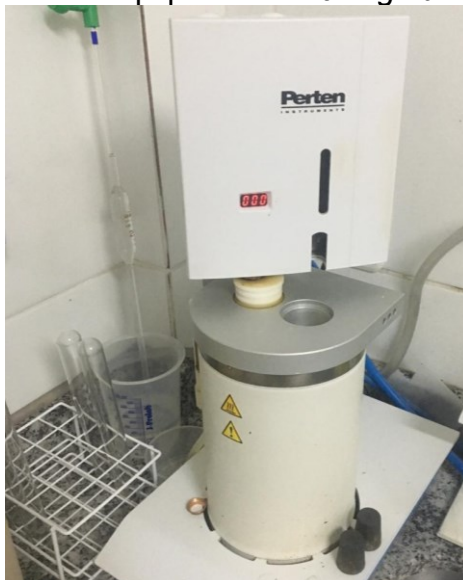
Figura 2 - Equipamento Falling number .
