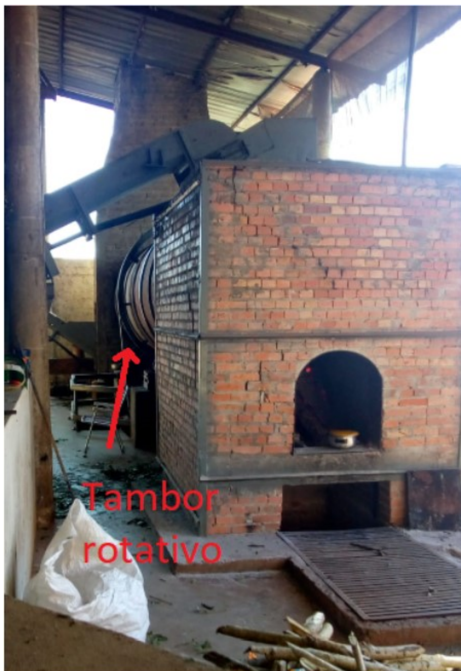
Figura 7 – Tambor rotativo para sapeco. Fonte: Autoria própria (2021).
