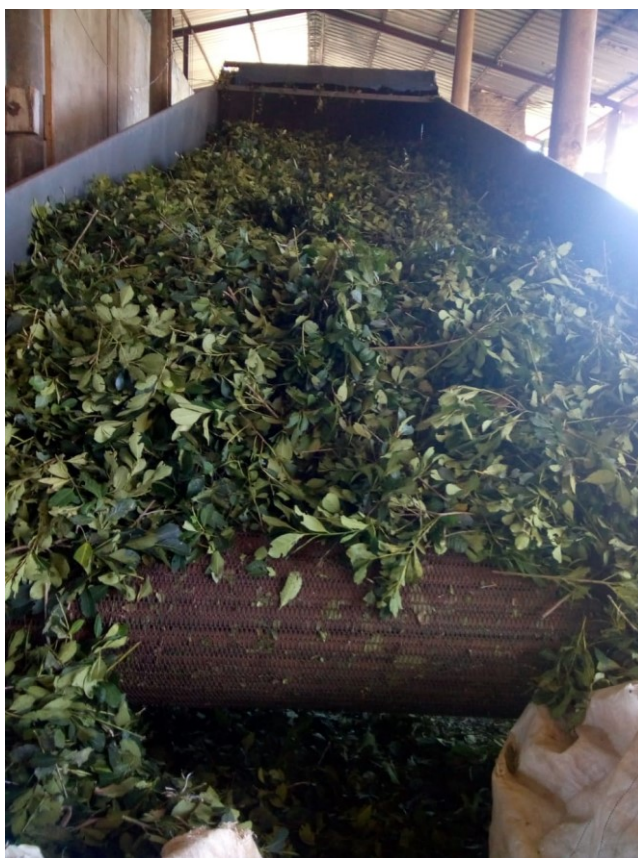
Figura 6 - Esteira de pré-seleção de erva-mate. Fonte: Aatoria própria (2021).
