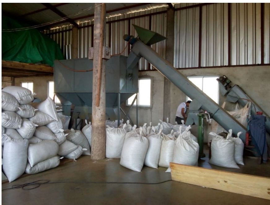
Figura 8 - Separação das folhas e galhos de erva-mate secos.
