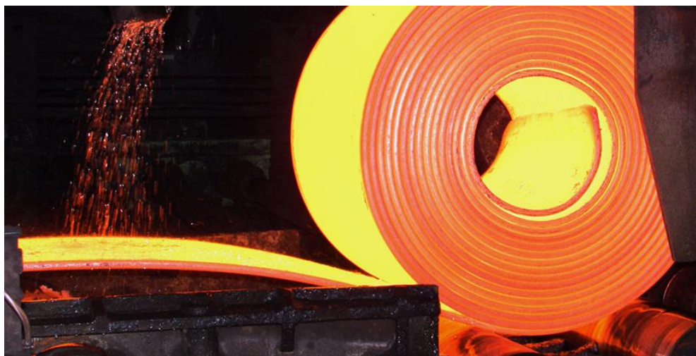
Figura 4 - Chapa em processo de laminação a quente.
