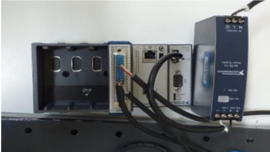
Figura 19 – CompactRIO utilizada para processamento e controle da bancada
