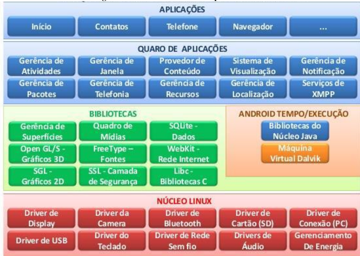
Figura 2 – Estrutura do sistema operacional Android
