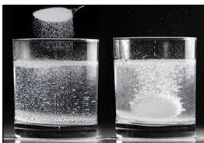
Figura 2. Efeito da Superfície de Contato na Velocidade da Reação.
