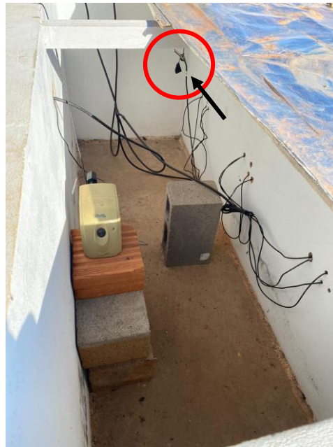
Figura 10: Localização do sensor no interior do modelo
