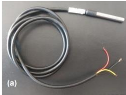
Figura 9: Sensor de temperatura DS18B20
