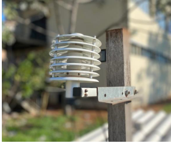
Figura 11: Abrigo com o sensor DS18B20
