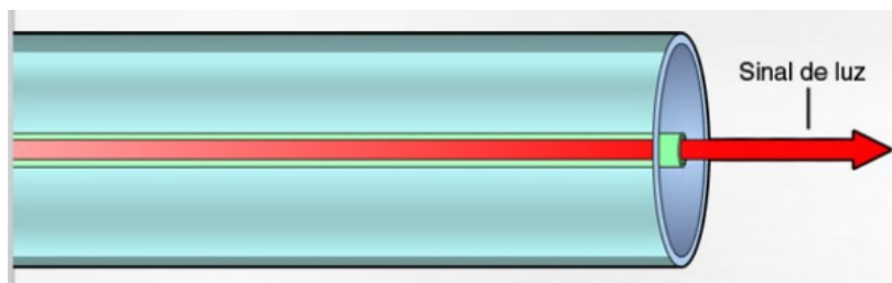
Figura 3: Ilustração da fibra óptica monomodo Fonte: Hamann (2017).
