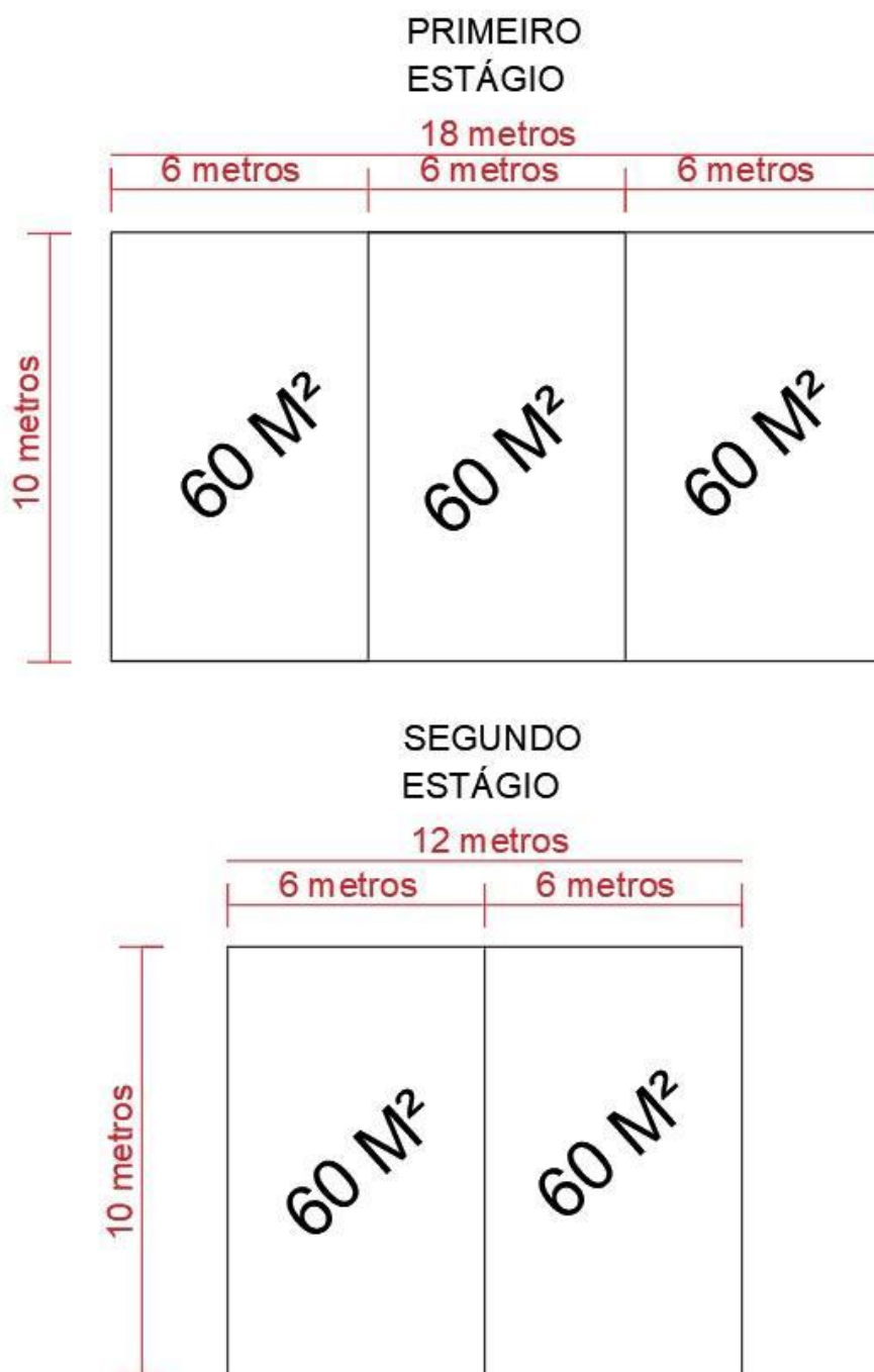
Figura 19 - Dimensões do wetland francês para atender todo efluente gerado pelo restaurante universitário.
