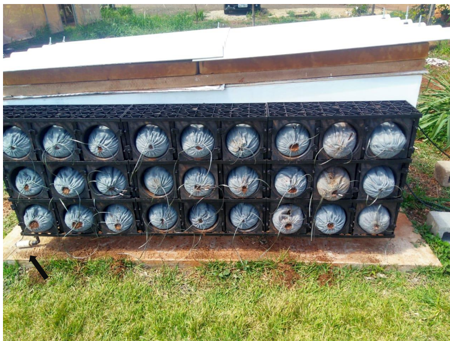
Figura 24 - Vista do experimento com módulo contendo apenas substrato, instalado no BPV
