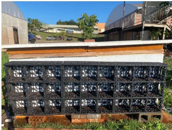
Figura 22 - Módulo de parede verde pré-moldado da empresa WallGreen instalado no modelo construído
