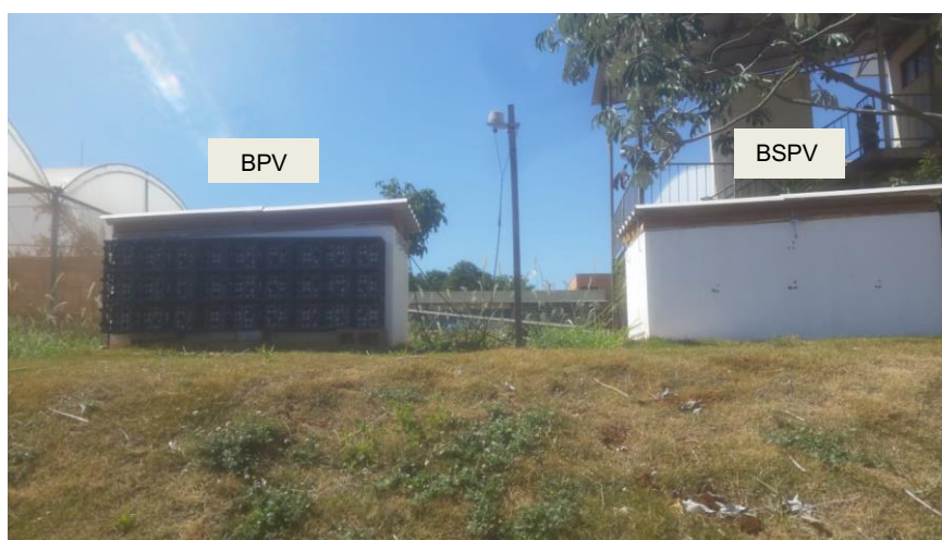
Figura 23 - Modelos construídos com e sem a implementação do módulo de parede verde
