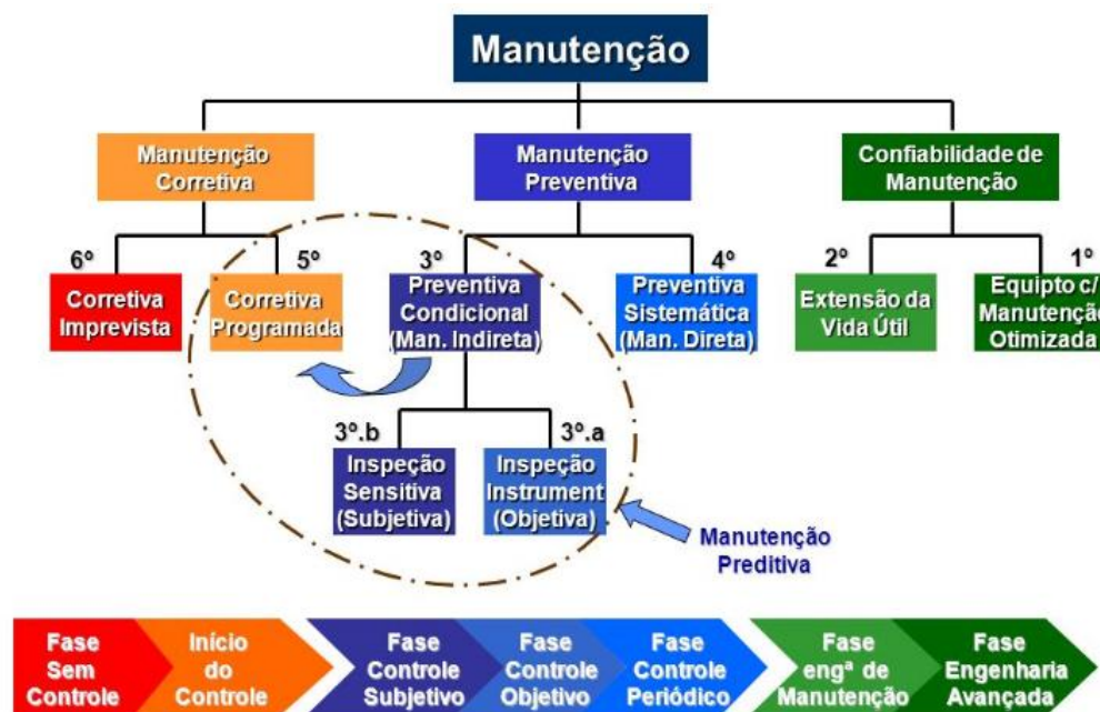
Figura 1: Fluxograma dos tipos de manutenção Fonte: Indústria hoje, (2017).
