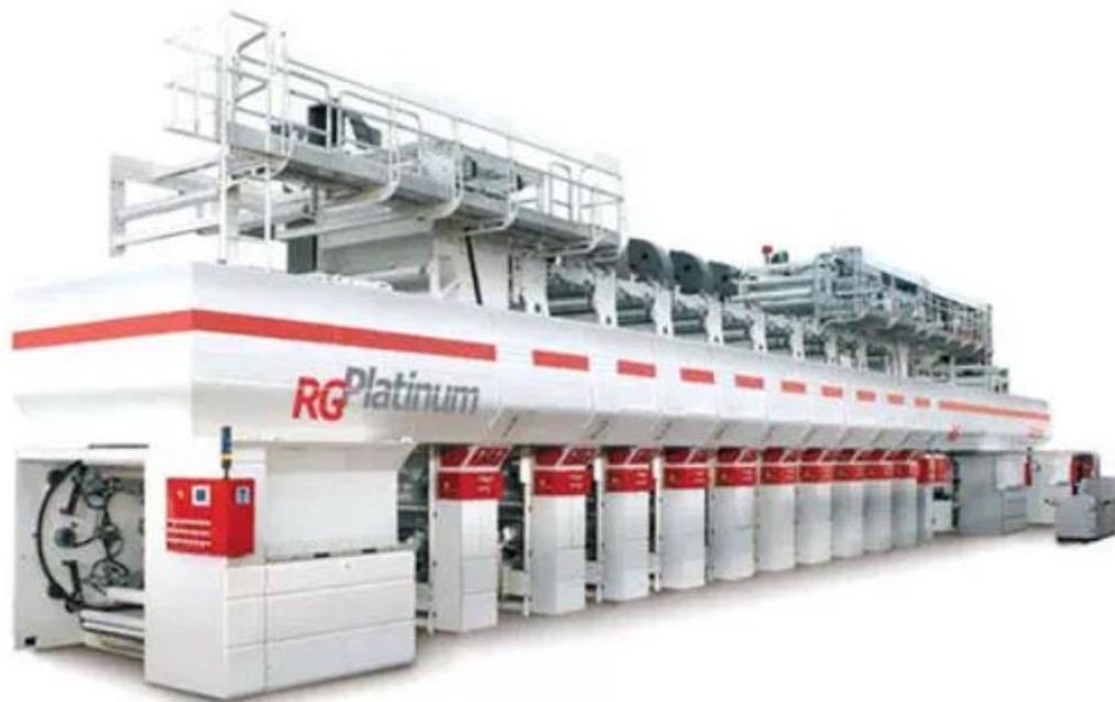
Figura 7. Impressora de rotogravura com laminação em linha.
