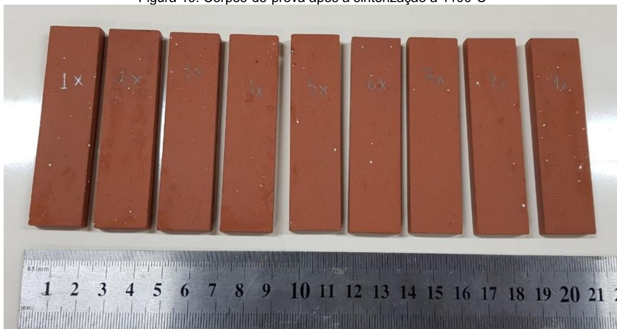
Figura 19: Corpos-de-prova após a sinterização a 1100°C
