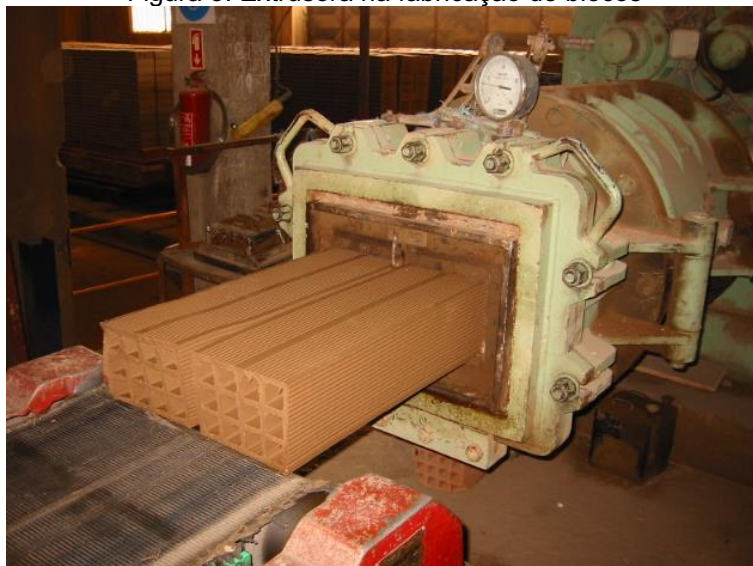
Figura 3: Extrusora na fabricação de blocos
