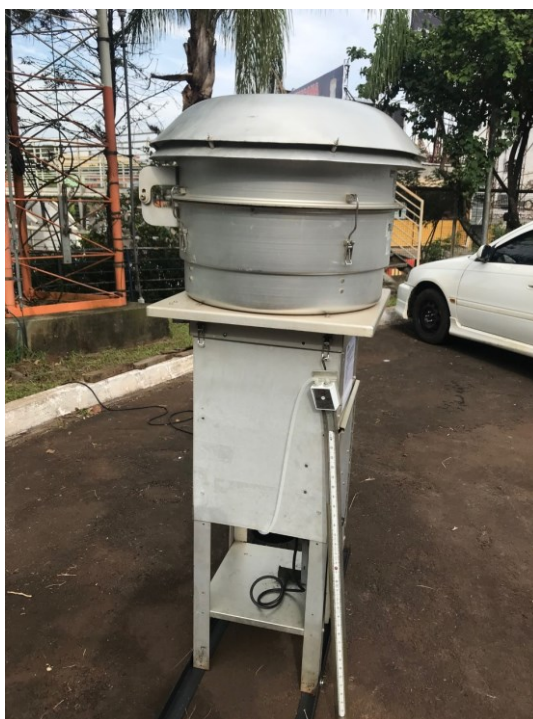
Figura 4 - Amostrador Hi-vol MP 10 . Instalado na área de estudo.
