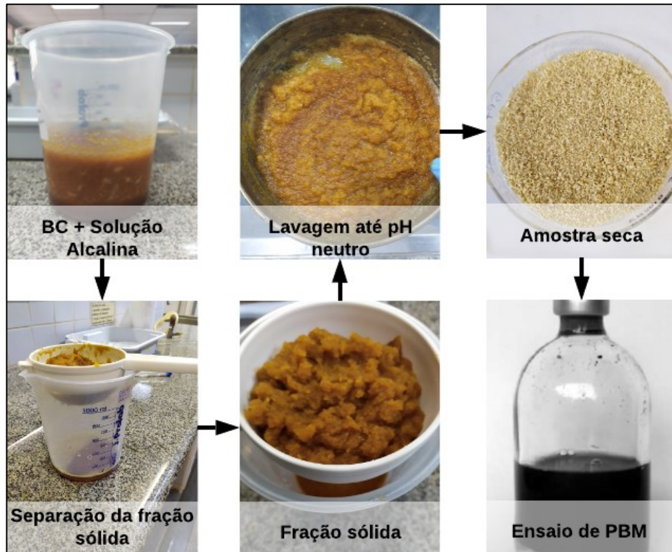
Figura 12 - Pré-tratamento de BC com NaOH e KOH
