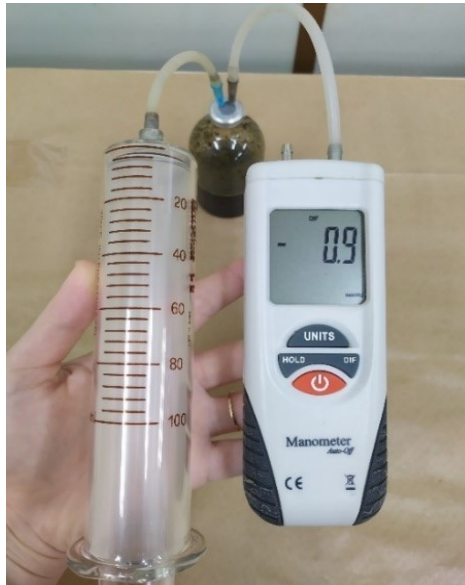
Figura 14 - Medição de biogás com seringa de vidro e manômetro
