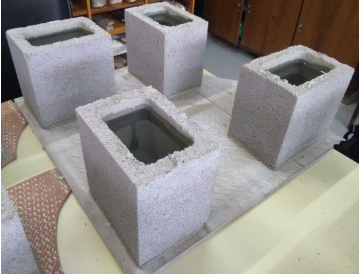
Figura 18 - Reservatório com Techplus Top.
