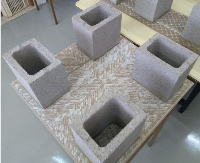
Figura 9 - Reservatório para teste de estanqueidade.
