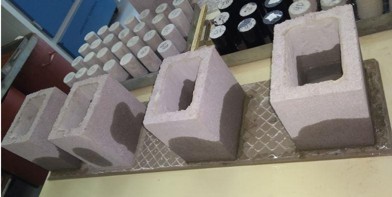
Figura 16 - Reservatório com argamassa ACIII.
