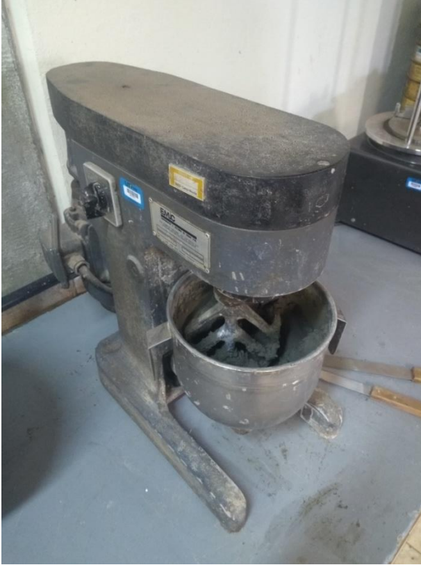
Figura 1 - Preparação da argamassa no misturador.
