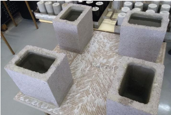
Figura 19 - Reservatório com Vedatop.
