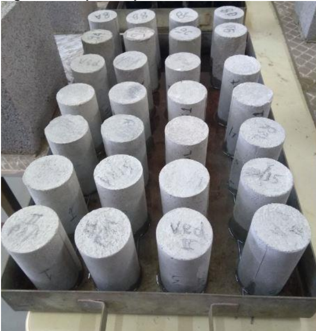
Figura 7 - corpos-de-prova submetidos à imersão parcial em água.
