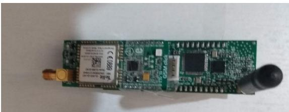
Fig. 6a. Transmissor desenvolvido a partir do componente LoRa acoplado a um módulo GPS telite.
