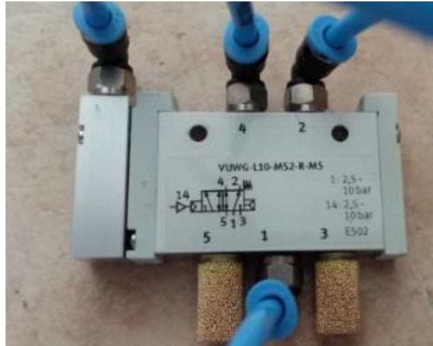
Figura 18 - Válvula pilotada de retorno por mola 5/2 vias Fonte: Autoria própria (2021)
