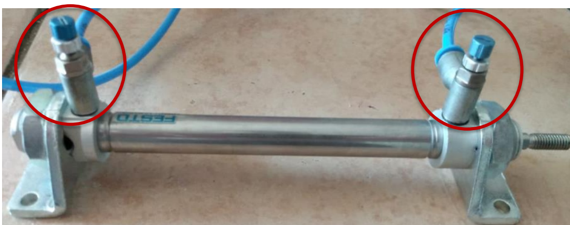
Figura 19 - Conexões reguladoras de fluxo acopladas ao atuador de posicionamento de formas Fonte: Autoria própria (2021)
