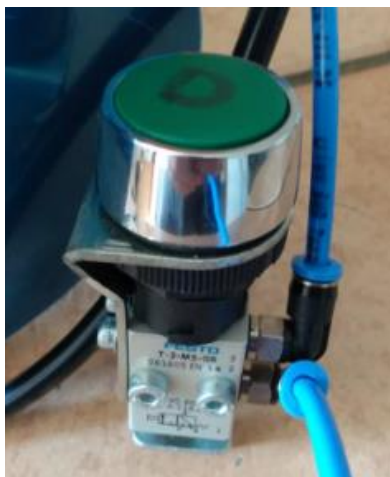
Figura 17 – Válvula 3/2 vias de acionamento dos atuadores Fonte: Autoria própria (2021)
