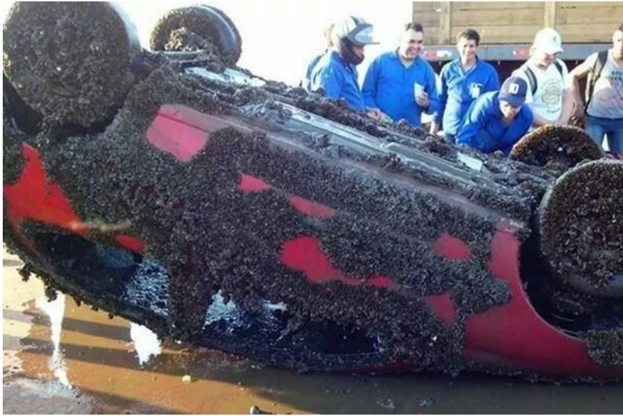
Figura 4. Macrofouling de mexilhão dourado em veículo que se encontrava imerso no rio Tietê na região de Araçatuba-SP.
