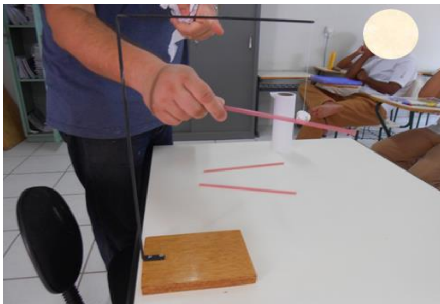
Figura 2. Suporte para amarrar a bolinha de isopor envolvida em papel alumínio
