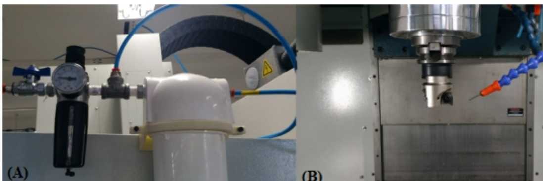
Figura 19 - Sistema para aplicação no método MQL, tanque de armazenamento (a) e saída do fluido (b).
