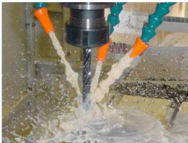
Figura 12 – Aplicação por jorro do fluido de corte semissintético com vazão total de 1230 litros por hora.
