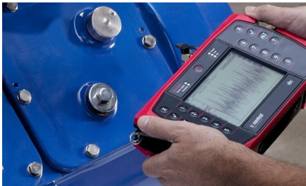
Figura 11 - Operador obtendo uma análise espectral. Fonte: Fluke (2020).
