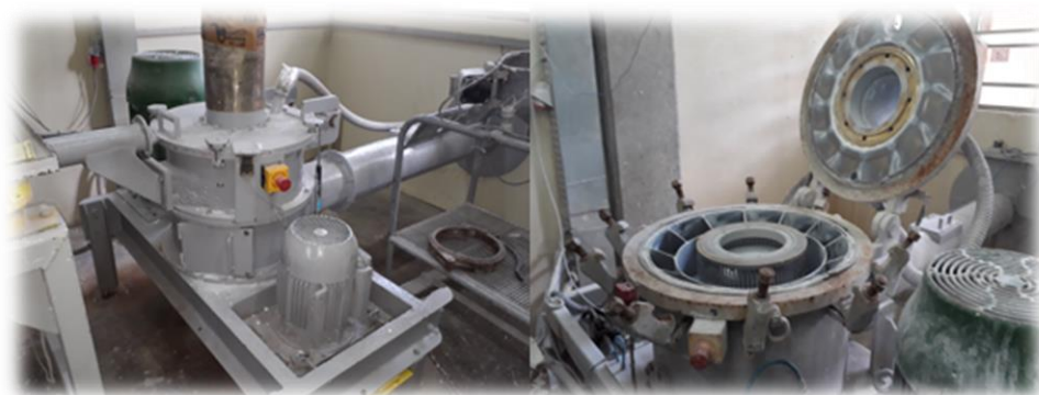
Figura 8 - Moinho classificador de tintas em pó Fonte: Dados da Pesquisa (2020)
