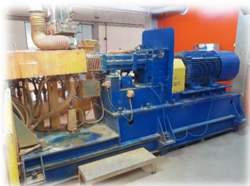
Figura 4 - Extrusora de tintas em pó Fonte: Dados da Pesquisa (2020)
