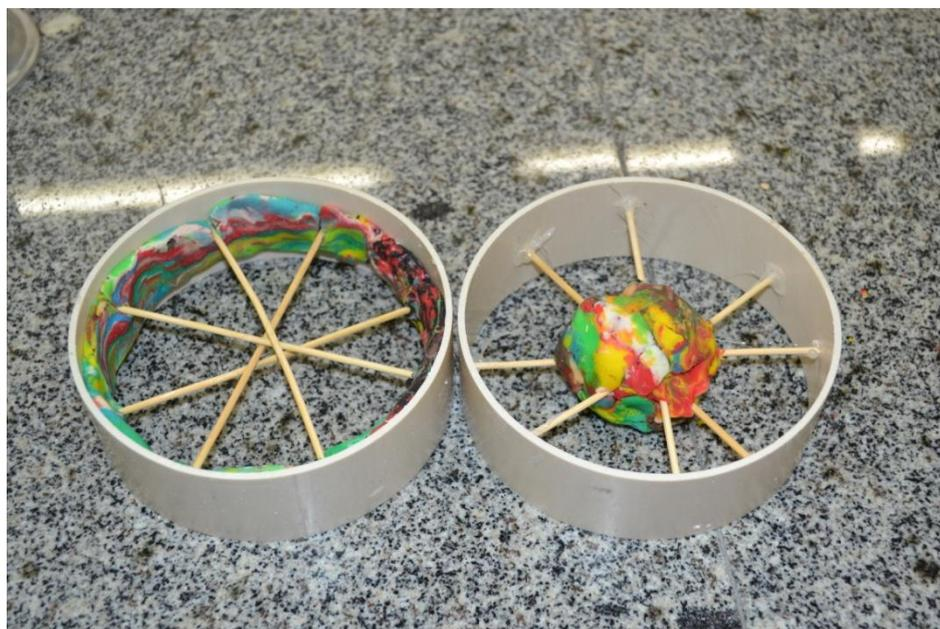
Figura 14 - os dois anéis de PVC, com a massa de modelar na extremidade (esquerda) e com a massa de modelar centrada (direita). Fonte: autoria própria
