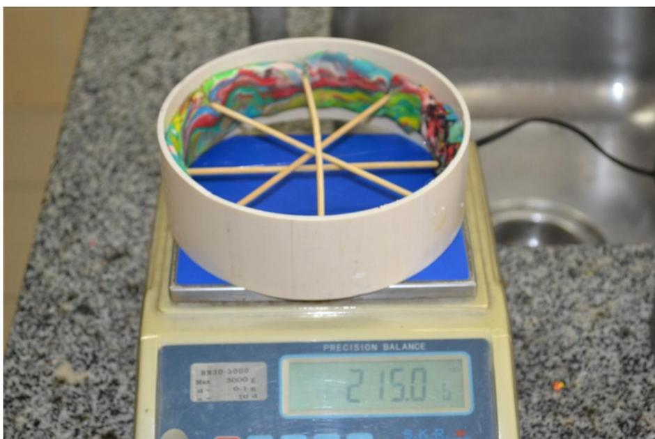
Figura 16- medida da massa do anel com a massinha de modelar externamente. Fonte: autoria própria
