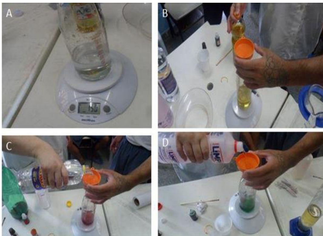
Figura 14. (A) Aferição da massa dos 150 mL de água dentro do picnômetro. (B) Aferição da massa de 150 mL de óleo de cozinha no picnômetro. (C) Aferição da massa de 150 mL de querosene no picnômetro. (D) Aferição da massa de 150 mL de álcool no picnômetro.
