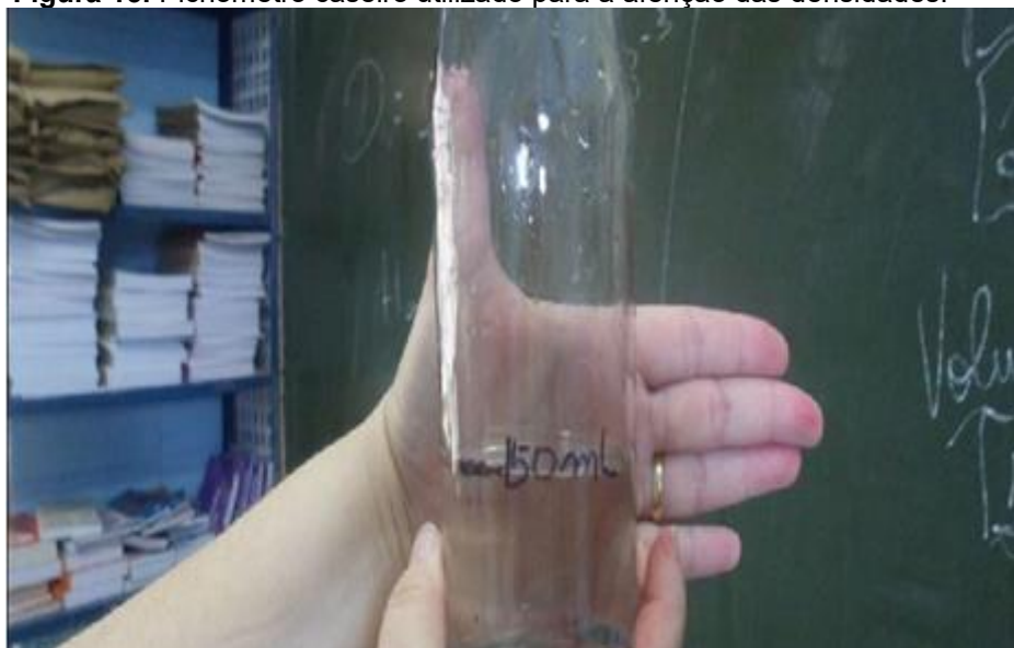
Figura 13. Picnômetro caseiro utilizado para a aferição das densidades.
