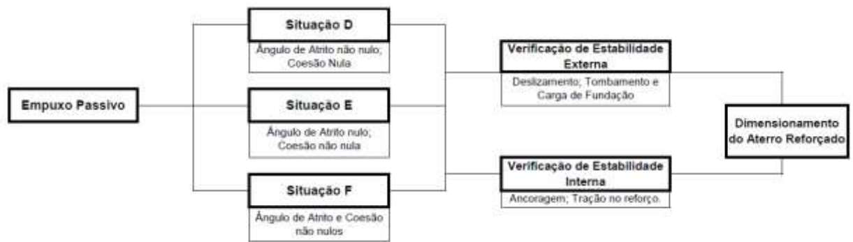
Figura 9 - Fluxograma de Empuxo Passivo para casos D, E e F. Do Autor, 2019.
