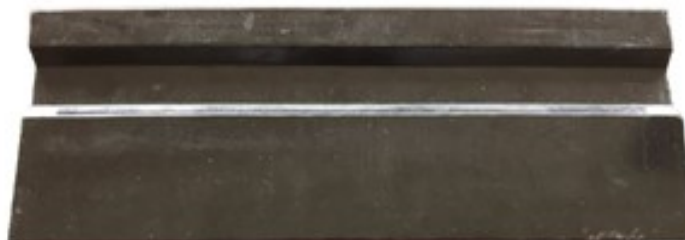
Figura 24 - Protótipo similar a estrutura de rodapé, confeccionado com 60% de Pneus em fim de vida
