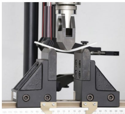
Figura 11 - Equipamento para o ensaio de resistência à flexão em material polimérico
