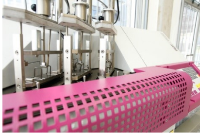
Figura 12 - Equipamento para realização do ensaio de resistência à deflexão térmica
