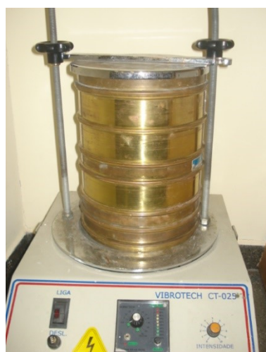
Figura 9 - Equipamento para peneiramento Vibrotec CT 25 (UTFPR-PG)
