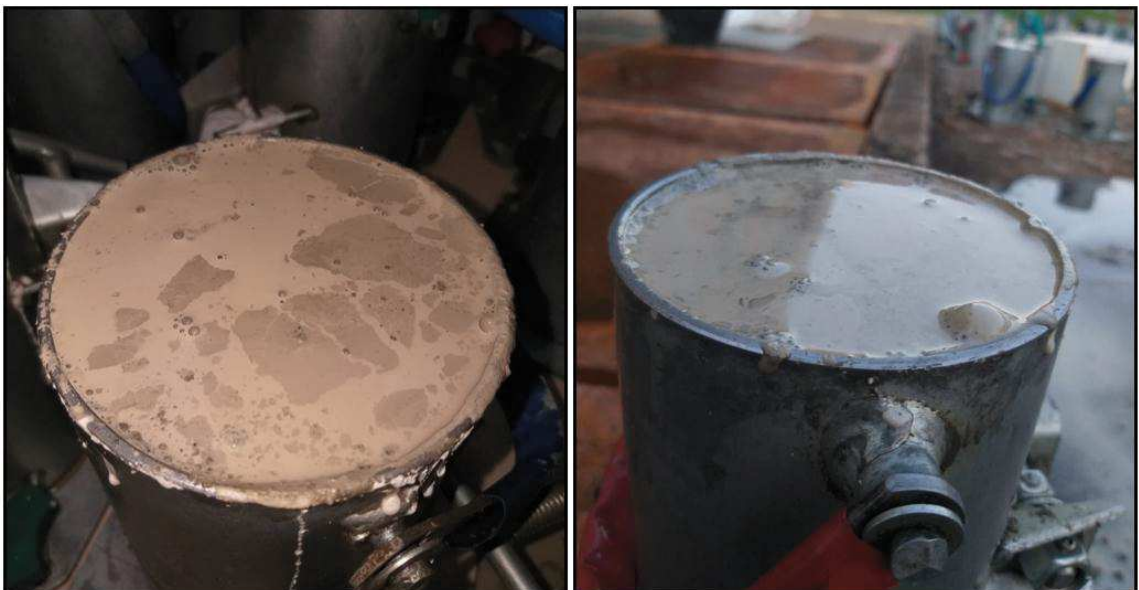
Figura 15: Exsudação do concreto K3
