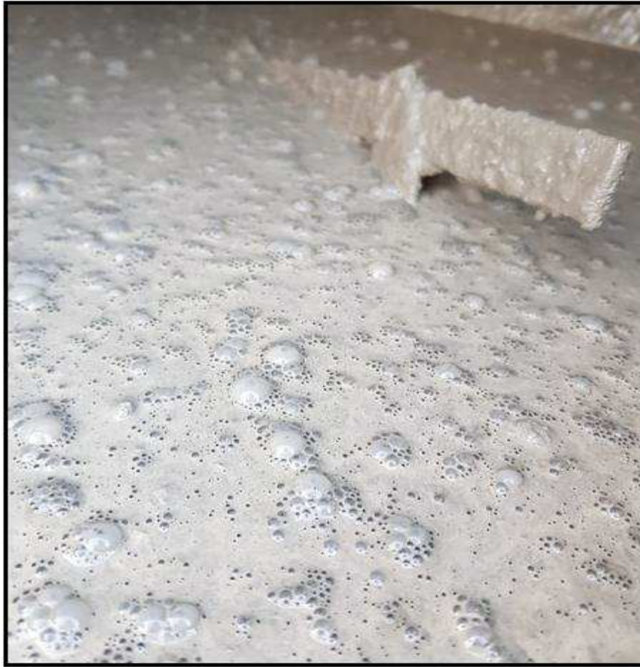
Figura 13: Surgimento de bolhas na superfície do concreto
