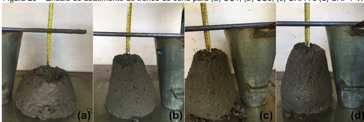
Figura 20 – Ensaio do abatimento do tronco de cone para (a) CC1, (b) CC0, (c) CRFA e (d) CRF-PVA
