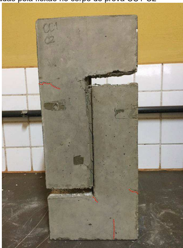
Figura 25 – Fissuras geradas pela flexão no corpo de prova CC1-C2
