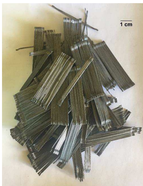
Figura 11 - Fibra de aço da Wirand modelo FF1 da Wirand®
