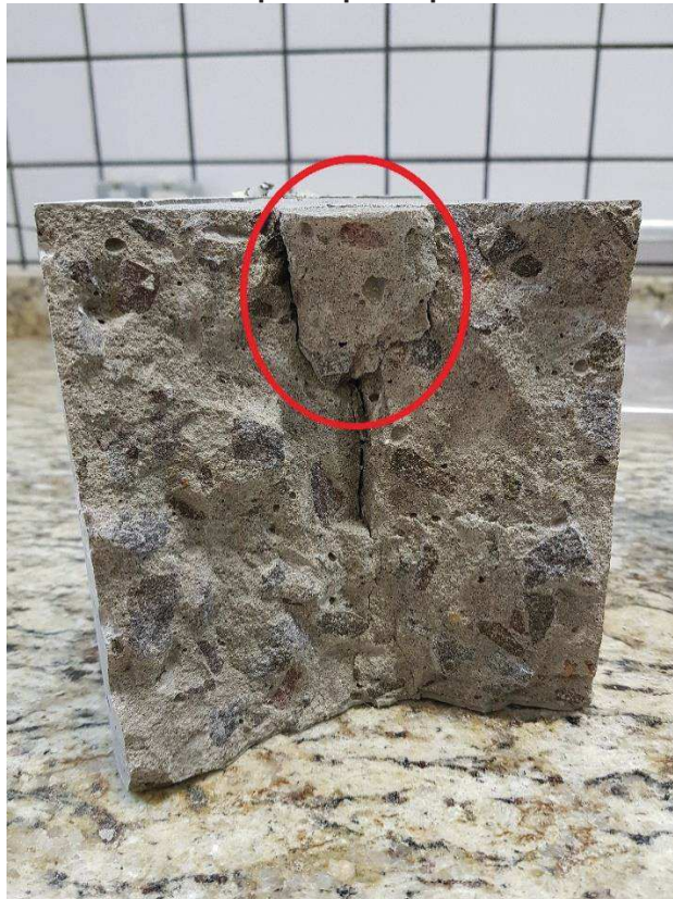
Figura 20 – Cunha cônica formada no corpo de prova pelo ensaio Barcelona
