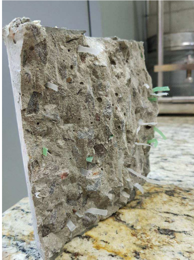
Figura 22 – Evidência do arrancamento das fibras da matriz
