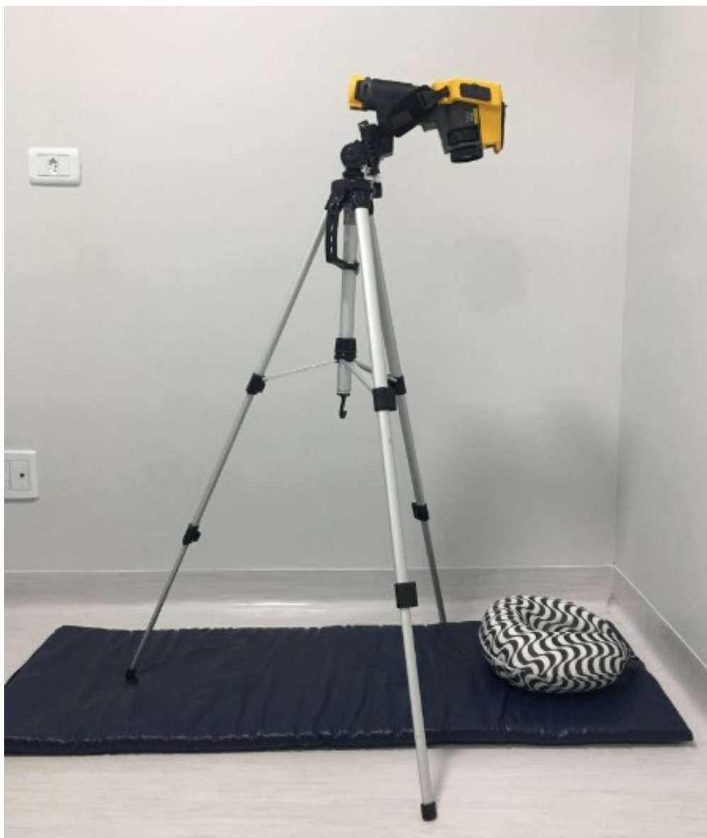
Figura 7: Posicionamento da câmera termográfica para a coleta das imagens
