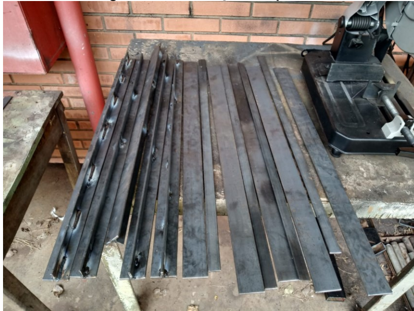
Figura 19 - Fabricação dos perfis T
