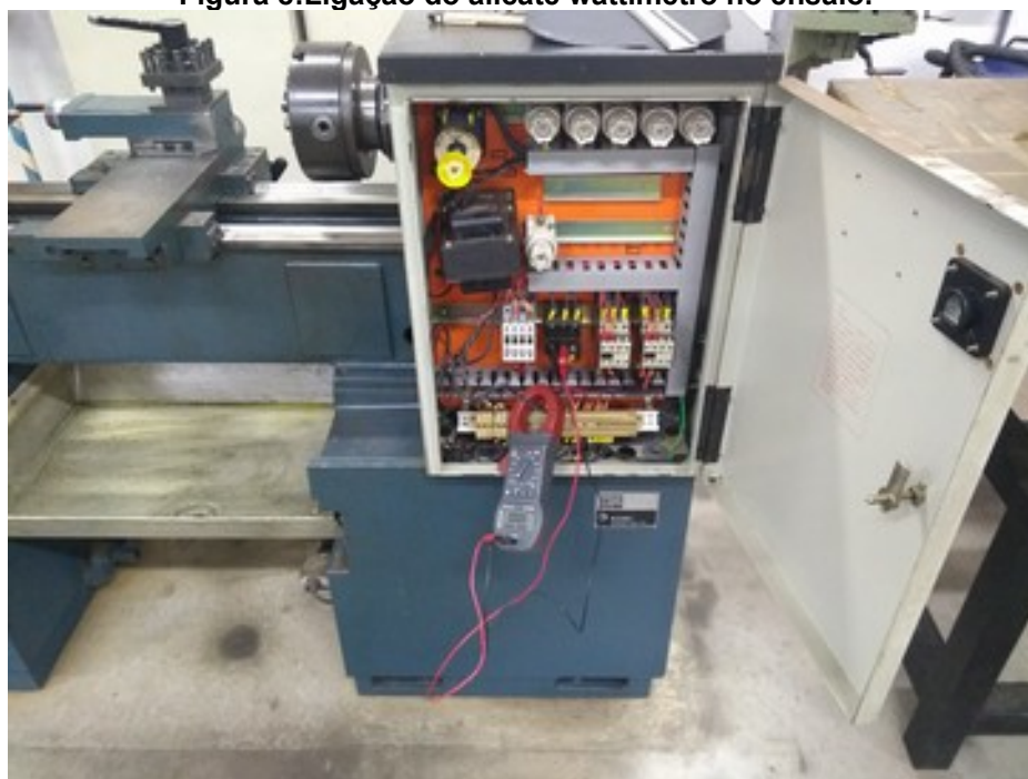
Figura 8: Ligação do alicate wattímetro no ensaio.
