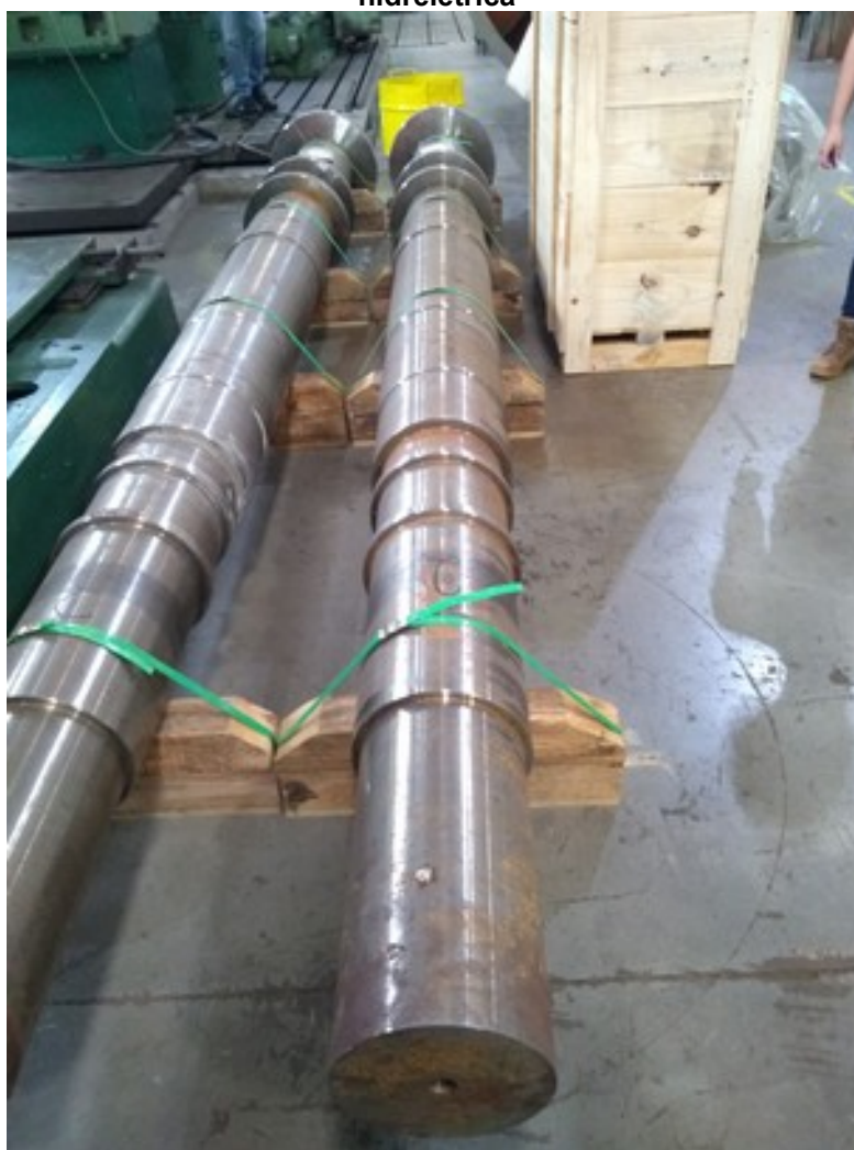
Figura 2: Eixo utilizado em gerador de uma pequena central hidrelétrica
