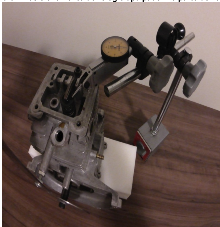
Figura 6 – Posicionamento do relógio apalpador no parto de válvula.
