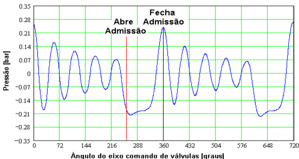
Figura 3 - Variação de pressão medida na base da válvula, fora da câmara de combustão, em função da variação dos graus do ângulo válvula.
