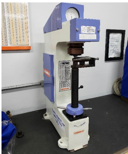
Figura 34 - Equipamento para ensaio de dureza HRC.
