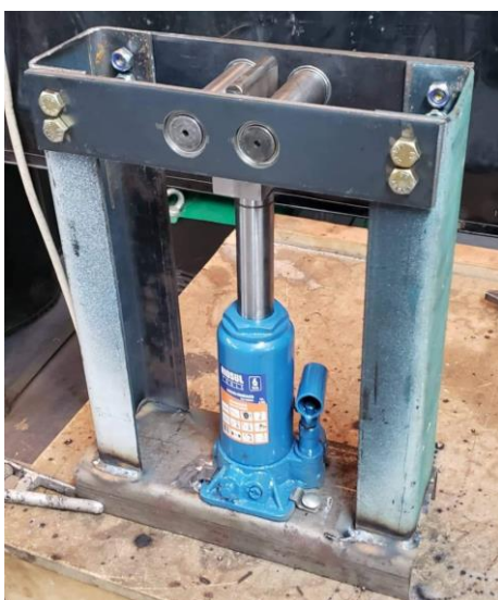
Figura 35 - Dispositivo de dobramento em fase de montagem.
