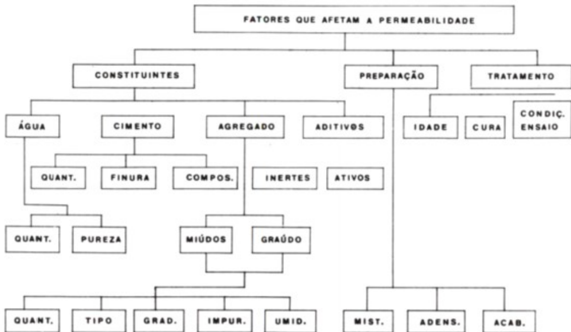
Figura 1 – Diagrama dos fatores que influenciam a permeabilidade do concreto.
