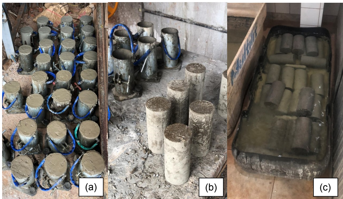
Figura 14 – Processo de moldagem (a), desmoldagem (b) e cura dos concretos (c).
