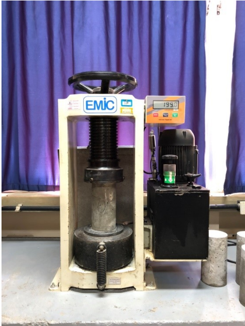
Figura 17 – Ensaio de resistência à compressão.
