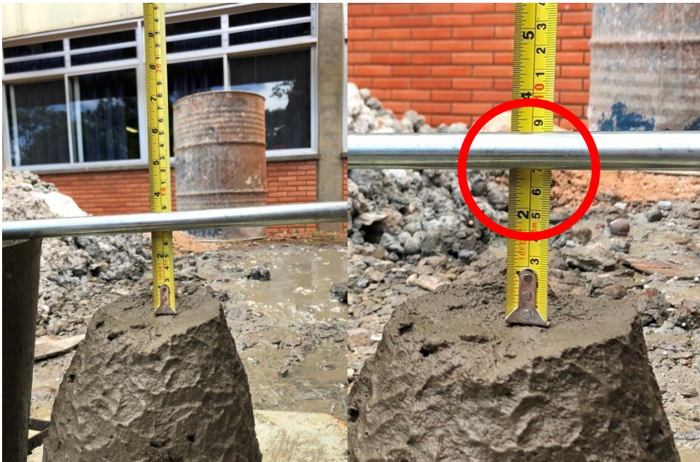
Figura 22 – Medida do abatimento do concreto com 10% de lodo.
