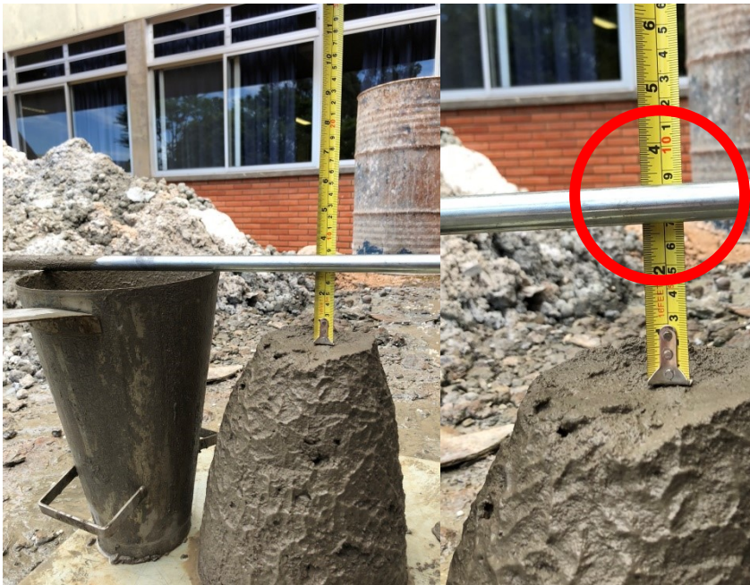
Figura 21 – Medida do abatimento do concreto com 5% de lodo.
