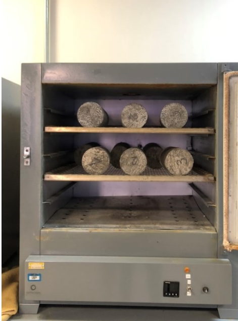
Figura 18 – CP's na estufa para secagem.
