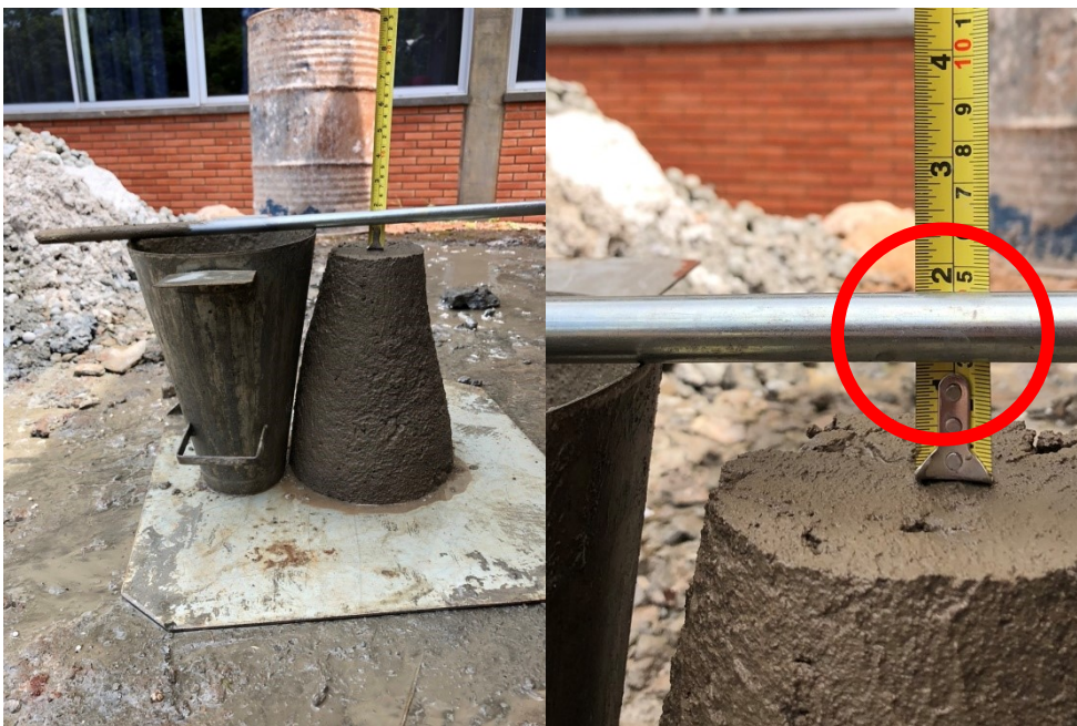
Figura 23 – Medida do abatimento do concreto com 15% de lodo
