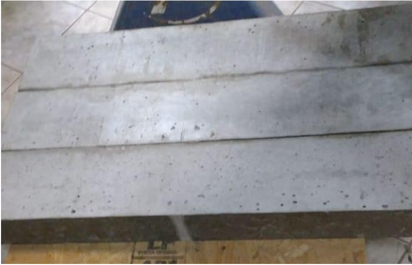
Figura 37: Vigas após o desmolde.
