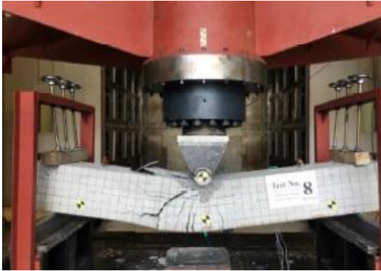
Figura 21: Viga de concreto armado não reforçada após o ensaio de impacto.
