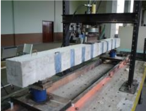
Figura 7: Viga preparada para ensaio estático.
