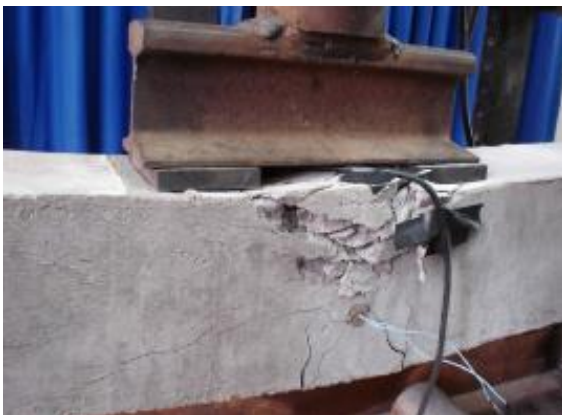
Figura 8: Ruptura em ensaio estático da viga.
