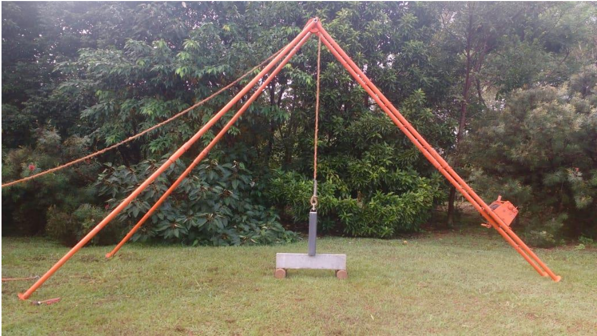
Figura 40: Sistema utilizado no ensaio de impacto em viga de concreto de armado.
