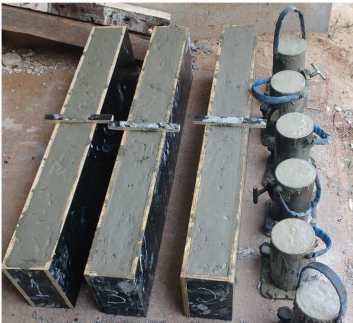
Figura 36: Vigas e corpos de prova após a concretagem.
