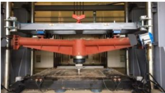
Figura 20: Máquina de teste de impacto com peso reduzido.
