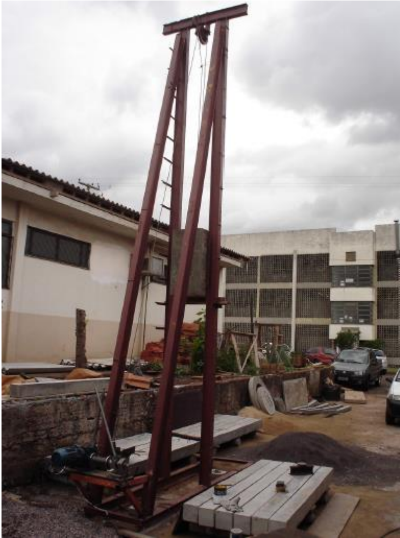
Figura 5: Aparato para aplicação da carga de impacto.
