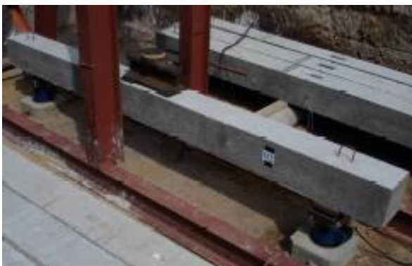
Figura 6: Viga preparada para ensaio dinâmico.
