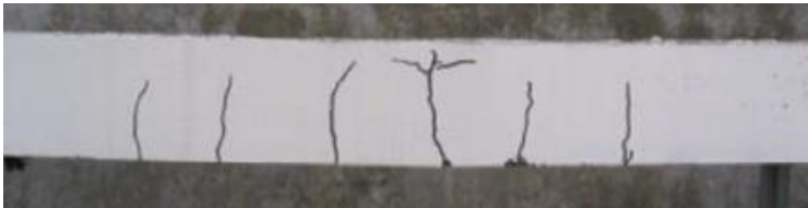
Figura 16: Modos de falha a uma altura de 100mm no teste de impacto único.
